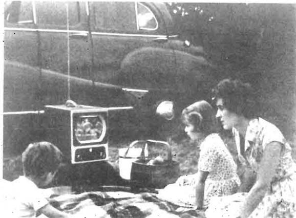
Televisore portatile costruito dalla E. K. Cole, che può essere alimentato dalla rete c. c. o c. a. o dall'accumulatore della autovettura.
